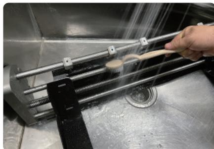
03.用清水喷淋下料架，未清洗干净处再次喷洒除油剂，用毛刷刷洗，再用清水冲洗干净。
