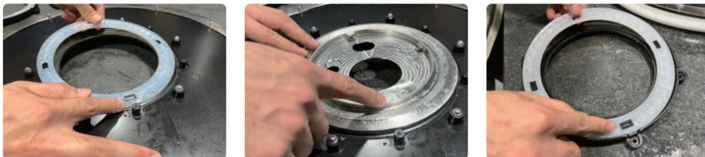
4、锅盖下转圈对准锅盖固定圈上后,双手捏紧将锅盖固定圈对准锅盖的螺丝孔套上,然后用螺丝全部拧紧固定,最终将安装好的锅盖安装回机器上即可。
