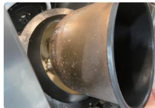
⑤ 旧锅取出后,准备好需要换上的新锅,在炉芯上有六块温度传感器,使用我司提供的针管工具将导热硅脂挤出将六块铜壳表面涂满导热硅脂。
