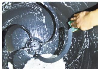
2、如果以上方案不能清洗干净，就采用热水加洗洁精和小苏打浸润主炒菜区域20分钟以上，再进行手动擦洗干净，然后使用喷枪进行喷水清洗。
