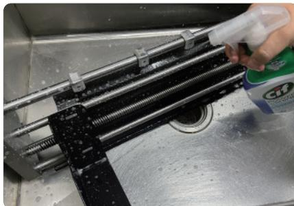
02.把下料架放入清洗池中，下料架全面喷涂除油剂，静置15~30分钟后必须用清水清洗。
