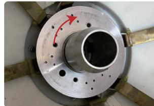
⑦ 用手抓住锅沿,对准换锅工装后,缓缓放入,放入时旋转锅将锅底螺丝孔位与炉芯孔位相对应,然后将换锅工装逆时针旋转取出后,妥善保管。
