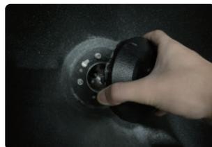
⑨ 拨叉座放入时,注意将中心“D型孔位”对准锅底部的“D型孔位”,顺时针旋紧,如果遇到阻力,用手转动中心部位,然后继续旋动拨叉座,拧紧为止。
