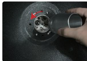
⑧ 将换锅工装取出后,将螺丝依次拧入螺丝孔位中拧紧,然后将拨叉座对准中心放入锅底。
