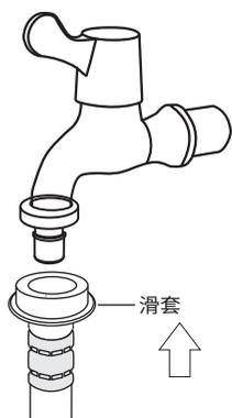
向下滑动滑套,将进水管主体向上套在水龙头出口。
