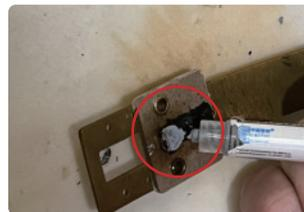
⑥ 准备好我司提供的换锅工装,将有螺纹的那一边对准炉芯底部顺时针旋紧。
