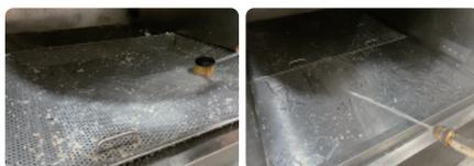
对出菜位和沥水盘滤网进行擦拭清洁，建议使用泡沫型油污清洁剂，然后使用喷枪进行冲洗，冲洗时喷头朝下方，避免炉芯部件进水。
